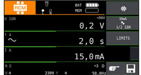
Nach Ablauf von 10 s darf kein Fehlerstrom signalisiert werden. Anschließend muss die Messung bewertet werden. Bei Bewertung mit **NOT OK** (falls Fehlalarm) erfolgt eine Fehlersignalisierung über die rot leuchtende LED **UL/RL**.
