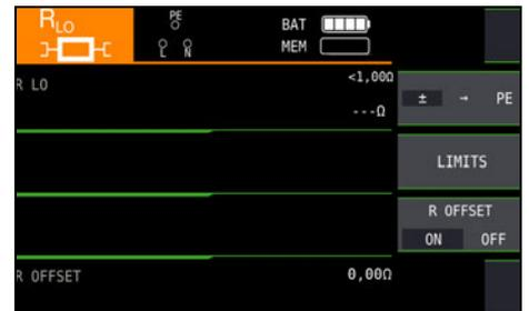
In der Fußzeile des Displays erscheint nun die Meldung **ROFFSET x.xx W**, wobei x.xx einen Wert zwischen 0,00 und 10,0 Ω annehmen kann. Dieser Wert wird nun bei allen nachfolgenden  $R_{LO}$ -Messungen vom eigentlichen Messergebnis subtrahiert, sofern Sie die Softkey-Taste **ROFFSET ON/OFF** auf **ON** geschaltet haben.
