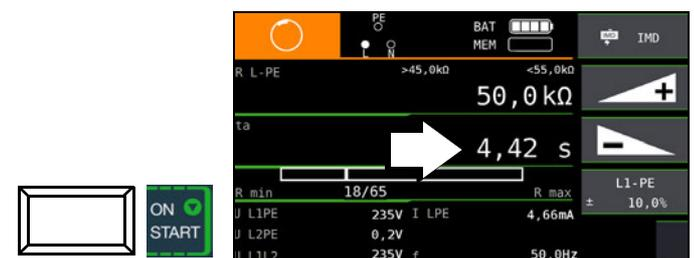
Die Messung kann durch Drücken von **ON/START** oder **ESC** abgebrochen werden.
