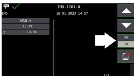
Über die nebenstehende Taste (**MW:** Messwert/**PA:** Parameter) können Sie sich die Einstellparameter zu dieser Messung anzeigen lassen.
