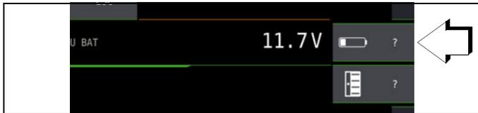
Ist die Akkuspannung kleiner oder gleich 8,0 V leuchtet die LED **UL/RL** rot, zusätzlich ertönt ein Signal.
