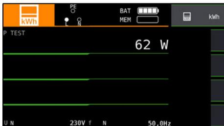
Der Zähler wird mithilfe eines internen Lastwiderstands und einem Prüfstrom von ca. 250 mA geprüft. Nach Drücken der Taste **Start** wird die Prüfleistung angezeigt und Sie können innerhalb der nächsten 5 s prüfen, ob der Zähler ordnungsgemäß anläuft. Das Rädchen für die laufende Messung dreht sich.
