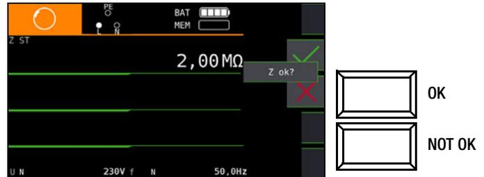
Die Widerstandswerte sind an mehreren Stellen zu messen, damit eine ausreichende Beurteilung möglich ist. Der gemessene Widerstand darf an keiner Stelle den Wert von 50 kΩ unterschreiten. Ist der gemessene Widerstand größer als 30 MΩ, so wird im Anzeigefeld immer  $Z_{ST} > 30.0 \text{ M}\Omega$  angezeigt.
