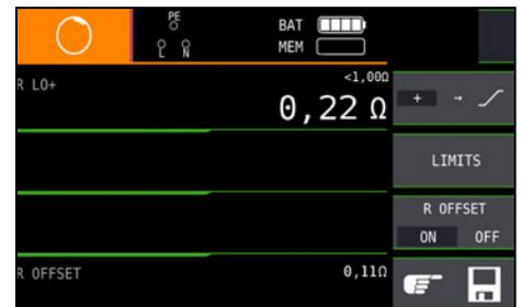
Während der Magnetisierungsphase (Kurvenanstieg) und der anschließenden Messphase (konstanter Strom) wird das Symbol rechts eingeblendet.
